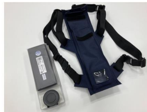
VPM装置と収納ケース（スマートフォン、RFIDリーダー、ボタン、収納ケース）
