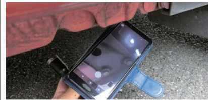
画像③スマホカメラや鏡を使用すると便利 (画像は新車時溶接)
