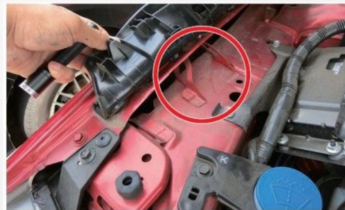
画像④衝撃は取付ステーからフロントインサイドパネルへ(画像は新車状態)
