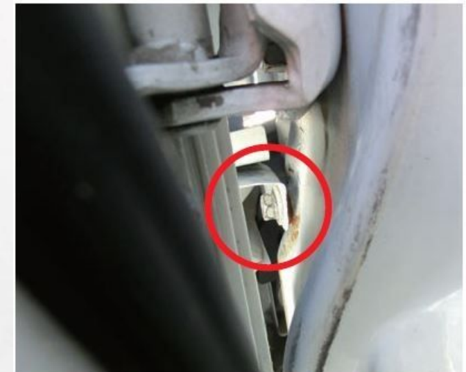
画像②フロントピラー側の取付ボルト (画像は回し跡有・ピラー損傷有)
