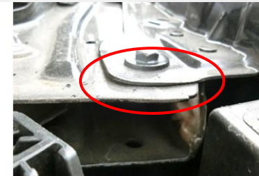
画像⑥左フロントインサイドパネル先端部分 こちらはフェンダーとの合わせ目が歪んでいる
