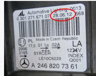
画像④ヘッドライトの製造年を年式と照合する (2012年6月28日製造)
