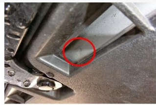
画像③アンダーカバーの抜き打ち穴越しに見える溶接跡 (画像は新車状態)
