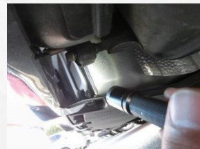
画像⑤カバー越しに見えるバンパーステー部分を確認する(画像は新車状態)
