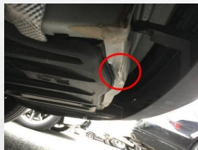
画像①リヤ下部エリアのみ損傷 (メルセデスベンツW204系Cクラス)
