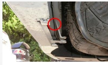
画像④バンパーステーとリヤエンドパネルの接合部分を確認する(画像は損傷小有)
