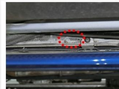
画像⑤裏側に残ったフレーム修正機跡
